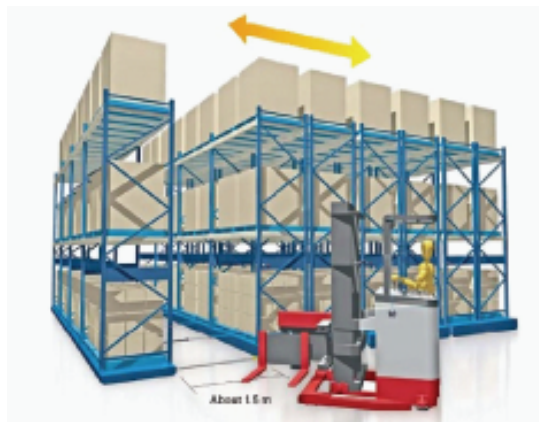
在1.5米的导轨通道,货位架通道在1.6米的通道内进行作业
