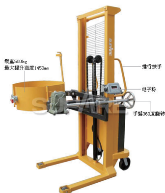
电子秤称，有置零、去皮、称重功能，精度可达±0.01g
