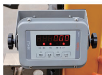
电子秤称，有置零、去皮、称重功能，精度可达±0.01g
